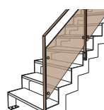
O4.HANDRAIL フラットバー +アクリルパネル
